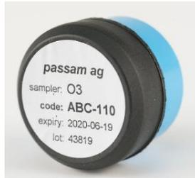
Der Sammler arbeitet nach dem Prinzip der passiven Diffusion: O<sub>3</sub>-Moleküle dringen in das Gehäuse ein und werden vom absorbierenden Medium aufgenommen. Die Probenahme erfolgt autark über 1 bis 4 Wochen. Ein integrierter Schutzfilter reduziert Umwelteinflüsse wie Wind und ermöglicht eine präzise Messung.
