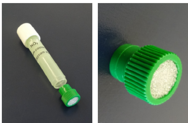
Passivsammler für Stickstoffdioxid mit Glasfrittenmembran
