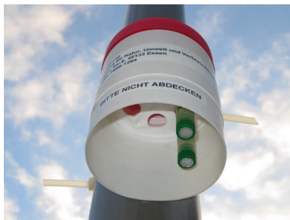
Aufhängevorrichtung als Schutz vor Witterungseinflüssen mit modifizierten Passivsammlern
