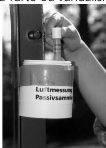
Montagem de amostradores difusos de NO 2 .
