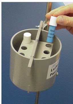
Installazione dei campionatori passivi per l'O 3
