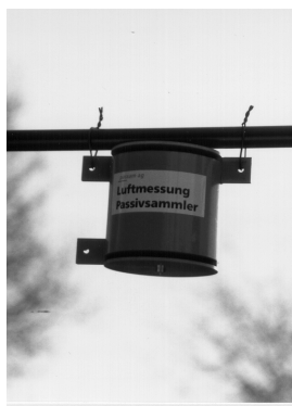
Installazione dei campionatori passivi per l'O 3
