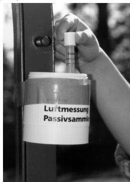
Colocación de tubos pasivos de NO 2
