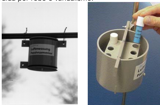
Colocación de tubos pasivos de Ozono
