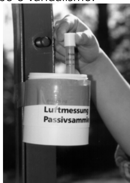
Colocación de tubos pasivos de NO 2
